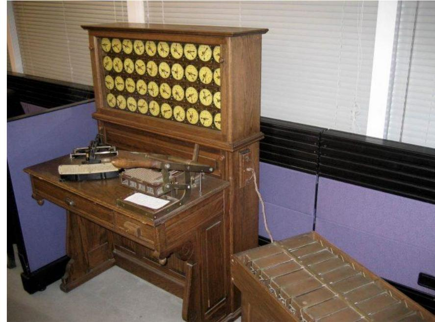
Hollerith Maschine, erstmals eingesetzt für Auswertung der US Volkszählung 1890. Bild zur Verfügung gestellt von [Adam Schuster](#) unter [CC-By Lizenz](#).
